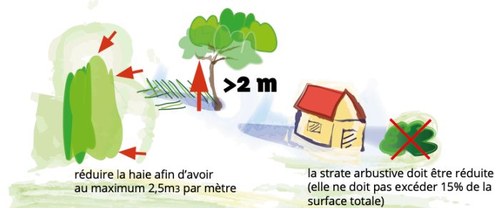
Schémas de principe pour la mise en œuvre du débroussaillage. Les distances d'espacement des végétaux entre eux ou vis-à-vis des installations sont toujours à considérer par rapport aux cimes et non par rapport au tronc.
